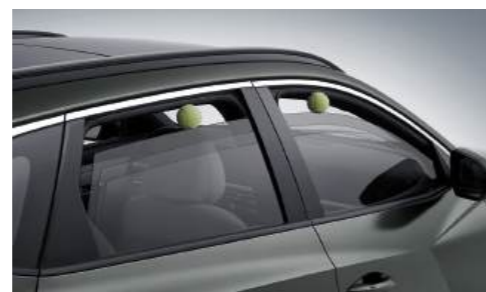
Ventanas eléctricas con función antipinzamiento
