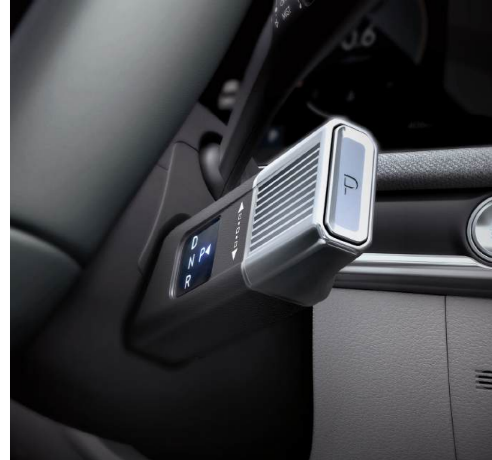
Cambio electrónico tipo columna (SBW)
